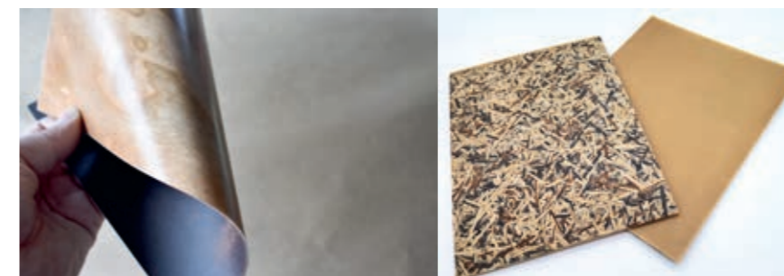
○ Links: Flexibles Naturoberflächenlaminat Rechts: Dekor aus Holzreststoffen erfolgreich hinterspritzt mit flammgeschütztem Biocomposite Left: Flexible natural surface laminate Right: Decor Veneer made out of wood residues back-injection molded with flame-retardant biocomposite
