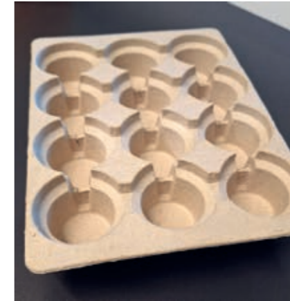
Faserguss-Verpackung zur Demonstration der Verarbeitbarkeit auf industriellen Faserguss-Produktionslinien. Fibre-cast packaging for demonstrating processability on industrial pulp moulding production lines.
