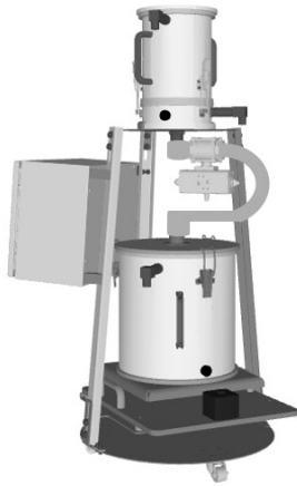
Schema des Labortestgeräts für die Entwässerungsmessungen (© Foto: Wood K plus)
