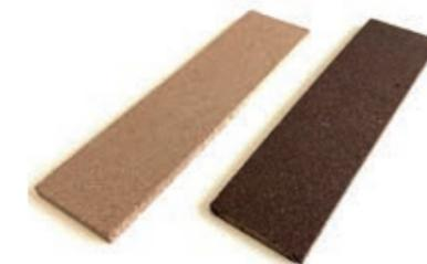
○ 100 % biobasierte Plattenwerkstoffe auf Basis von 90 % Buchenholzstaub (links.) bzw. 90 % Eichenholzstaub (rechts) und 10 % Polyhydroxyalkanoat
