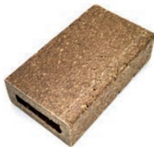
○ Prototyp des extrudierten Composite Bauteils zur Verwertung der Restfraktion
