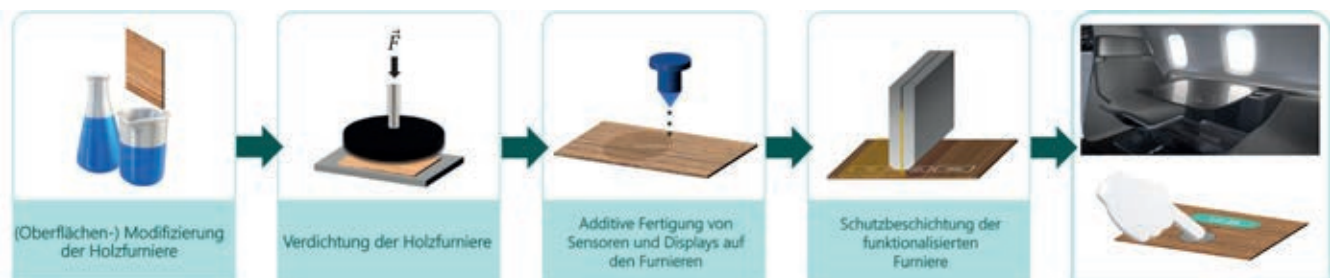
○ Prozessschritte der Sensorintegration auf der Echtholzoberfläche. Process steps of sensor integration on the real wood surface.
