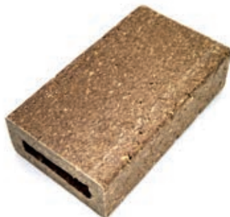
○ Prototyp des extrudierten Composite Bauteils zur Verwertung der Restfraktion Prototype of the extruded composite component for recycling the residual fraction
