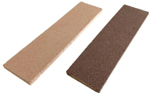
100% biobasierte Plattenwerkstoffe auf Basis von 90% Buchenholzstaub (links) bzw. 90% Eichenholzstaub (rechts) und 10% Polyhydroxyalkanoat (© Foto: Wood K plus)
