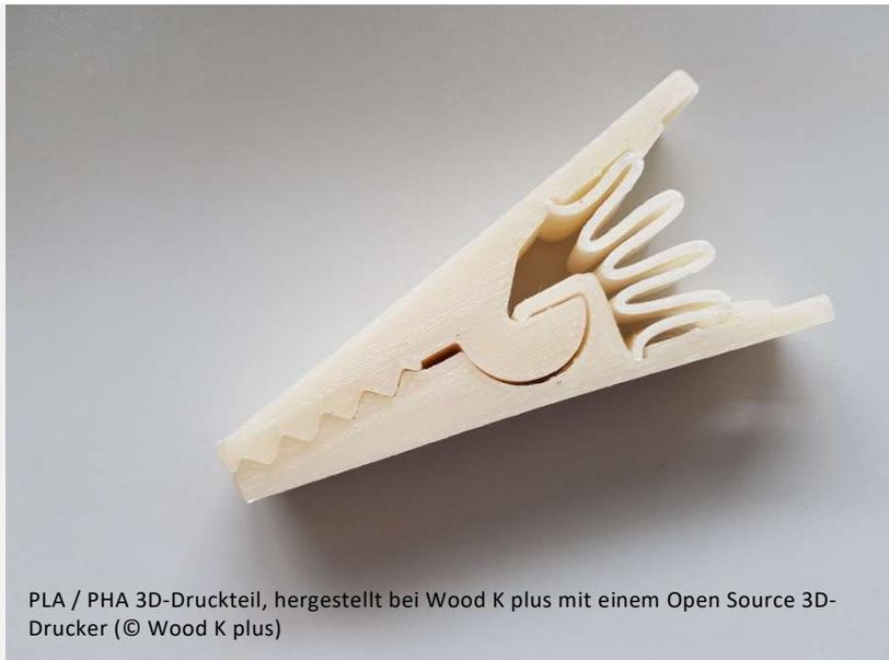
PLA / PHA 3D-Druckteil, hergestellt bei Wood K plus mit einem Open Source 3D-Drucker (© Wood K plus)
