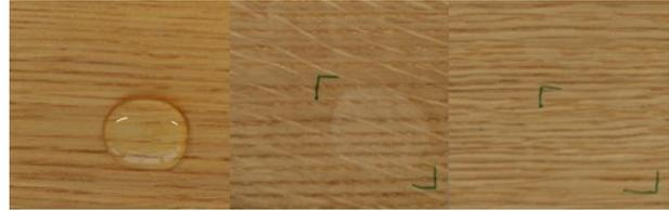
© Kompetenzzentrum Holz GmbH. Stehender Wassertropfen auf geölter Eichenholzoberfläche (links), belastete, rückgetrocknete Oberflächen: Vergleichsprodukt (Mitte) und Neuentwicklung (rechts).
