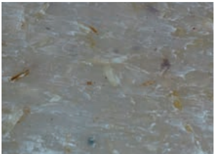
Spritzgegossene PP-NFC Platte, schwarz gefärbt und mit sichtbaren Holzfasern (oben), Vergrößerung der sichtbaren Holzfasern an der Oberfläche über Mikroskopie (unten). Injection molded PP-NFC plate, black colored with visible wood fibers (above, magnification of the visible wood fibers at the surface by microscopy (below).
