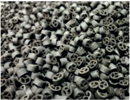
Extrudiertes Hohlgranulat aus Aktivkohle, Holzspänen und spezieller Polymermischung Extruded hollow granules made of activated carbon, wood sawdust and special polymer mixture
