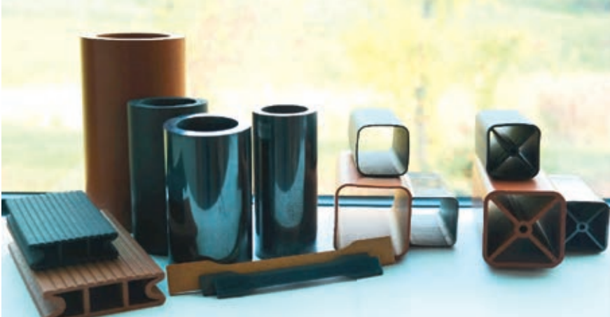
Unterschiedliche Prozessstufen und Geometrien von biobasierten SiC-Keramiken: Naturfasercomposite (braun) – poröser Carbonkörper (schwarz, matt) – SiC-Keramik (schwarz, glänzend) Different process stages and geometries of bio-based SiC ceramics: Natural fiber composite (brown) – porous carbon body (black, matt) – SiC (black, glossy)
