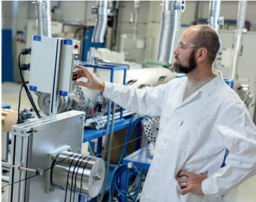
©UAR, Foto von: Hartwig Zögl: Wood K plus Mitarbeiter am Rohrofen bei der Herstellung von Carbonfasern aus Cellulose Wood K plus employees at the tube furnace during the production of carbon fibers from cellulose
