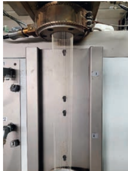
○ Schmelzespinnen von Fasern eines neuen biologisch abbaubaren PHA/PBAT Compounds Melt spinning of fibers of a new biodegradable PHA/PBAT compound
