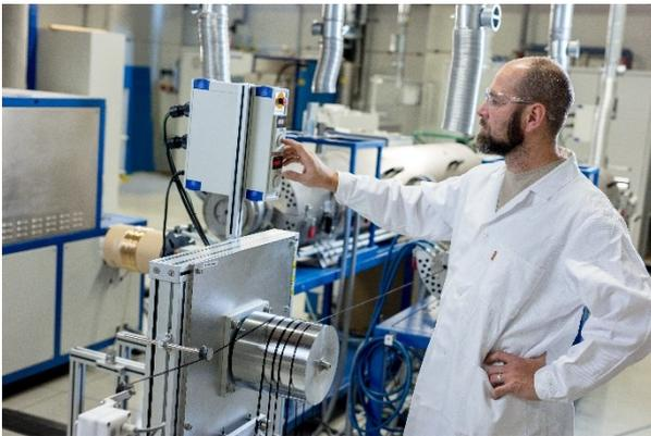
© UAR, Foto von: Hartwig Zögl: Wood K plus Mitarbeiter am Rohrfein bei der Herstellung von Carbonfasern aus Cellulose
