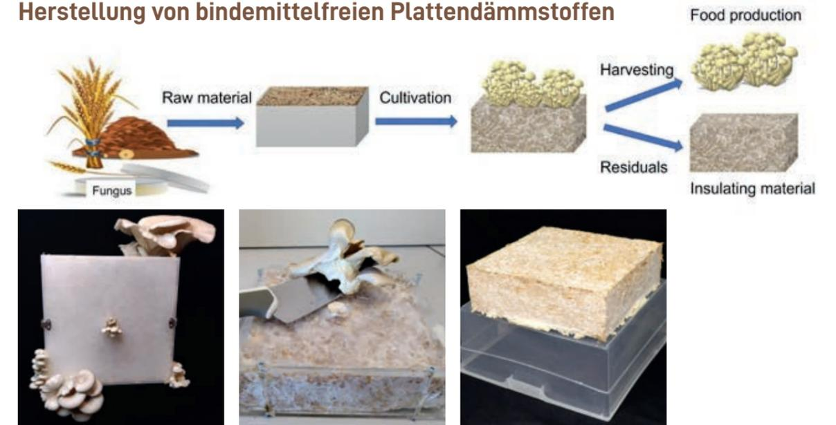
Erste Versuche zum dualen Wachstumsprozess von Mycomaterial für die Lebensmittelproduktion und Dämmstoffherstellung.
