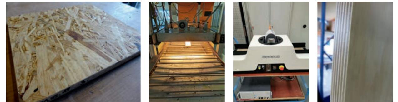
○ Auswahl von Pulverlackformulierungen appliziert auf unterschiedlichen Substraten → Thermoplastische, natürliche Pulver (Carnaubawachs, Bienenwachs, ...) auf OSB (links); UV-LED Pulverlacke auf OSB (Mitte); Klarlackpulverlack auf Sperrholz Kiefer (rechts)
