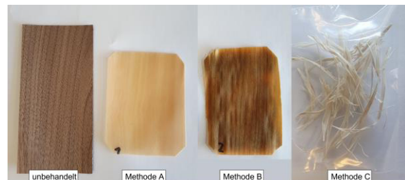
Ergebnisse verschiedener Flexibilisierungsmethoden, welche nicht die geforderten Kriterien erfüllten (©Wood K plus)
