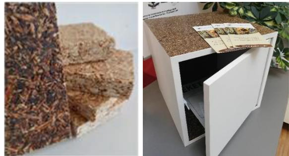
Vergleich von Holzwerkstoffen aus alternativen Klebstoffen und formaldehyd-reduzierten Bindemitteln (links), SusBind Möbelprototyp (rechts), © Wood K plus
