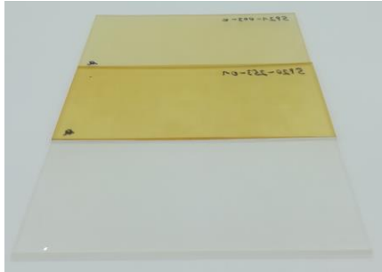
Abbildung 3: Deutliche Vergilbung nach künstlicher Bewitterung in Xenon-Prüfkammer (© Wood K plus)
